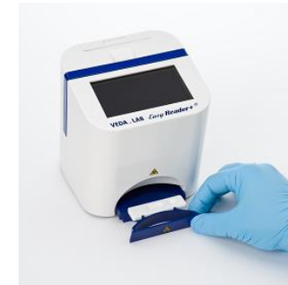
Abbildung 21: Die befüllte Testkassette in den Testkassettenhalter stellen und den Testkassettenhalter in das Messgerät schieben
