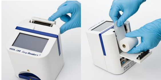
Abbildung 7: Scharnier des Druckerfachs zum Öffnen nach hinten schieben. Eine Rolle Thermodruckpapier in das Fach einlegen, sodass sie gerade zwischen den Ausrichtungsschienen sitzt. Die Paper Feed (Papiertransport)-Taste auf dem Hauptbildschirm antippen, um einige Zentimeter Papier über die Kante des Fachs zu transportieren.
