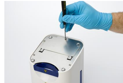
Abbildung 5: Schrauben an der Unterseite des Messgeräts lösen, um zum Batteriefach zu gelangen
