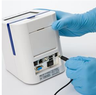
Abbildung 4: Anschließen des Netzgerätes an den EasyReader+
