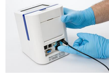
Abbildung 8: Zum Einschalten des Messgeräts sicherstellen, dass das Stromversorgungskabel angeschlossen ist. Anschließend den Ein/Aus-Schalter (nummeriert mit 11 in Abbildung 2 ) auf der Rückseite des Messgeräts betätigen.
