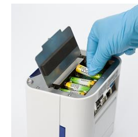
Abbildung 6: Beim Einlegen der Batterien stets auf die Polarität achten
