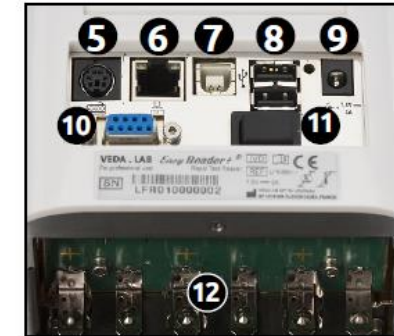
Abbildung 2: Rückansicht des Messgeräts EasyReader+ mit entfernter Bodenplatte
